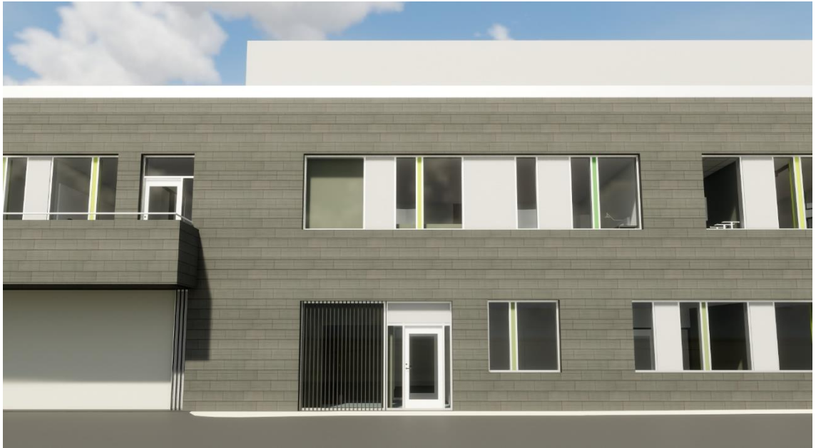
Fasadeutsnitt nybygg med platekledning fiberbetong
